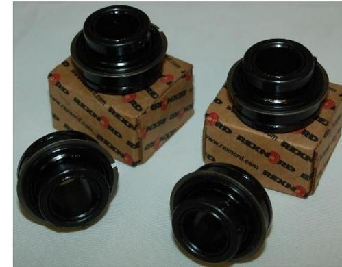
*Ce kit contient quatre roulement (diamètre 5/8" ou 1") : un avec un défaut de bague interne, un avec un défaut de bague externe, un avec un défaut d'élément roulant et un avec une combinaison de défauts.*
