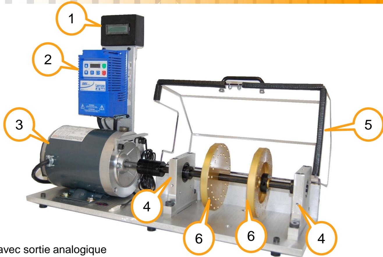
1. Tachymètre digital avec sortie analogique
